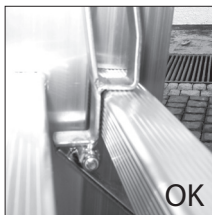
ATENCIÓN REVISÉ QUE EL GANCHO ESTÉ BLOQUEADO ANTES DE CADA USO
