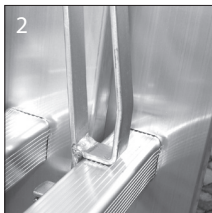
ATENCIÓN AL ESTADO DE DESGASTE DEL MUELLE
