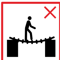
No utilice la escalera como puente.
