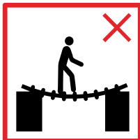
No utilice la escalera como puente.
