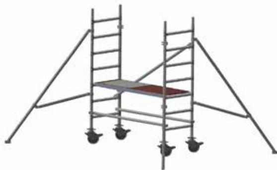
**PASO 1:** Instale el módulo base (véase apartado “MONTAJE DEL MÓDULO BASE” en la página 35) y retire temporalmente uno de los arriostramientos diagonales del módulo base.
