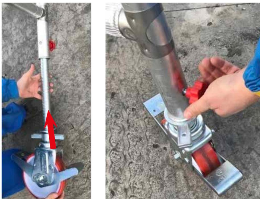
Coloque las ruedas regulables en los casquillos previamente montados y apriete finalmente el pomo de fijación.
