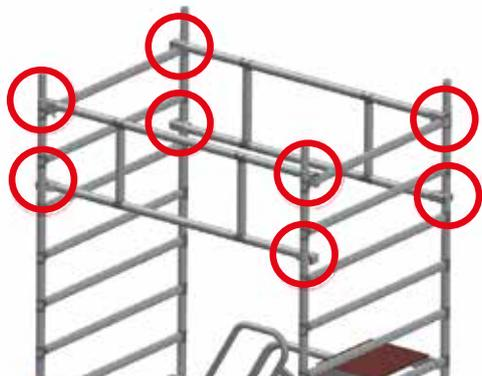
**PASO 9:** Coloque las barandillas de seguridad a lo largo de los laterales largos, delante y detrás. El enganche superior debe estar a la altura del 1er peldaño (desde arriba) de los bastidores laterales de 2,00 m.
