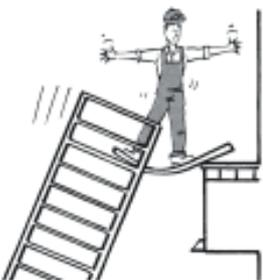
No está permitido realizar conexiones puente entre la torre en funcionamiento y un edificio u otra estructura que no forme parte de la torre.
