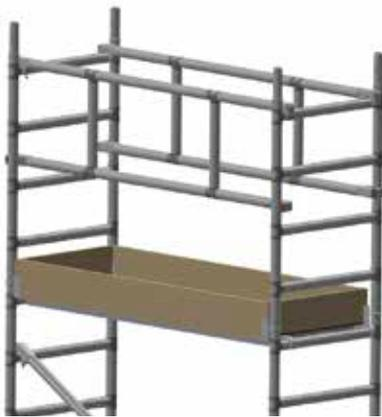
**PASO 8:** Colocar la plataforma de trabajo a la altura del 5o peldaño (contando desde arriba) de los bastidores laterales de 2,00 m.
