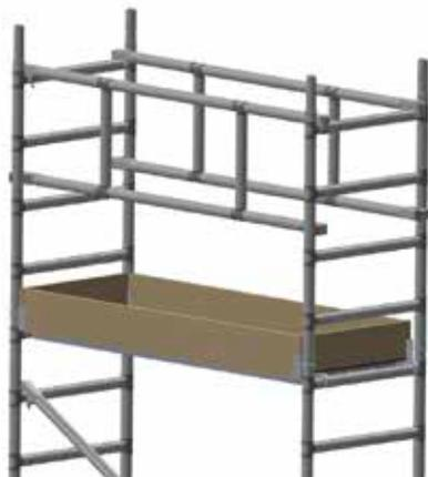
**PASO 4:** Colocar la plataforma de trabajo a la altura del 5o peldaño (contando desde arriba) de los bastidores laterales de 2,00 m.
