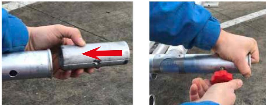
Coloque 2 casquillos en la base de cada uno de los dos bastidores laterales y bloquéelos ligeramente con el pomo de fijación correspondiente para que no se salgan. Para ello haga coincidir el taladro roscado del casquillo con el taladro pasante del bastidor, y una vez alineados, rosque el pomo de fijación.
