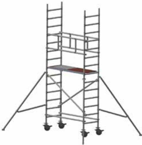
**PASO 3:** Coloque las barandillas de seguridad a lo largo de los laterales largos, delante y detrás. El enganche superior debe estar a la altura del 4º peldaño (desde arriba) de los bastidores laterales de 2,00 m.
