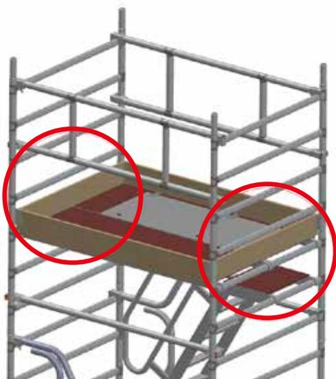
**PASO 10:** Coloque la plataforma de trabajo a la altura del 5o peldaño (contando desde arriba) de los bastidores laterales de 2,00 m.
