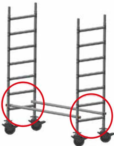
**PASO 1:** Alinee los dos bastidores laterales y fije dos travesaños en los laterales, sobre el 1er peldaño (contando desde abajo). Manténgase lo más cerca posible del peldaño para que el travesaño quede apoyado y no se desplace hacia abajo.
