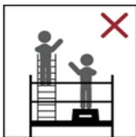
Está prohibido aumentar la altura de la plataforma mediante el uso de escaleras, cajas u otros dispositivos.
