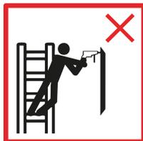
Evite los trabajos que impongan una carga lateral sobre las escaleras, como la perforación lateral a través de materiales sólidos.
