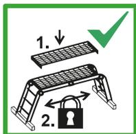
Si la escalera se utiliza como plataforma, sólo se utilizarán los revestimientos recomendados por el fabricante de la escalera. El entarimado deberá fijarse antes de su uso (solo si es necesario debido al diseño de la escalera).
