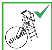
Utilizar sólo con estabilizador (si forma parte de la escalera).
