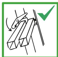
\*El símbolo muestra un diseño concreto que puede diferir del producto real. Los dispositivos de bloqueo deberán comprobarse y asegurarse completamente antes de su uso si no funcionan automáticamente.
