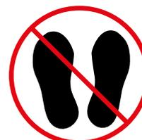
Cualquier superficie horizontal que parezca una plataforma en una escalera de pie que no esté diseñada para permanecer de pie sobre ella, deberá indicarse claramente en dicha superficie.
