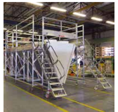
EM1109 Pasarela / Passadiço
