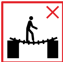
No utilice la escalera como puente.
