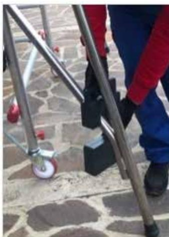
2) Fije los contrapesos a la viga de soporte del estabilizador inferior. El dimensionamiento de los lastres depende de configuración de montaje en cuestión. [Véase “CONFIGURACIONES DEL MONTAJE” en la página 19].
