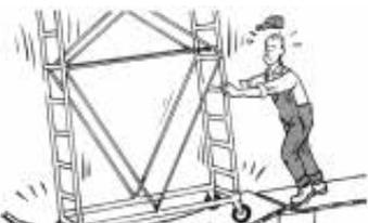
La superficie sobre la que se desplaza la torre móvil deberá soportar su peso. La superficie debe de estar nivelada, sin baches, pozos ni escalones. Durante el uso, si el terreno es irregular, coloque tabloncillos en los espacios vacíos bajo las ruedas o utilice una solución equivalente. Compruebe el peso (según el modelo) que cargará la superficie sobre la que se apoyará la torre.
