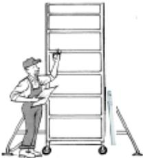
Al montar la torre móvil, compruebe que la plataforma base esté posicionado verticalmente con respecto al suelo (podrá comprobarlo con un nivel de burbuja). Antes de utilizar la torre móvil, compruebe que esta se haya montado de acuerdo con las recomendaciones del fabricante, ya que éstas garantizan un funcionamiento conforme a la normativa.
