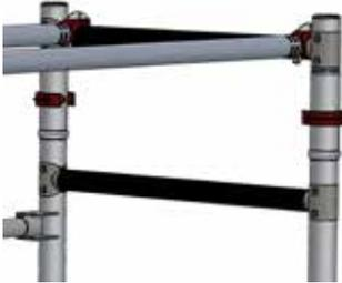
Los bastidores laterales deben plegarse y bloquearse con los dispositivos de bloqueo y fijación adecuados, dos por cada bastidor. El dispositivo de bloqueo debe montarse en la dirección desde el interior del bastidor lateral hacia el exterior de la torre.
