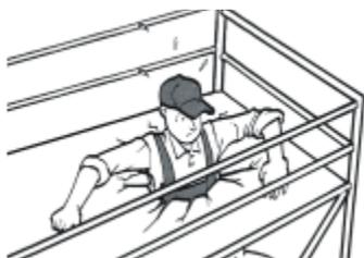
Está prohibido saltar sobre las plataformas y someterlas a cargas o personas cuyo peso supere la capacidad de carga especificada por el fabricante. Está prohibido subir a la torre móvil con escaleras, cajas u otros equipos, así como instalar elementos de apantallamiento como rejillas, lonas y otros.
